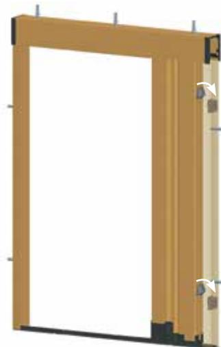
**N.B.** Para la versión de dos hojas, ambos perfiles laterales están dotados de clips de fijación y en el centro de la guía superior hará falta fijar, con tornillos y tacos, el fijo central.
