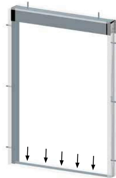
Separar la protección del adhesivo de la guía inferior y fijar al suelo. La guía debe quedar alineada con los perfiles laterales
