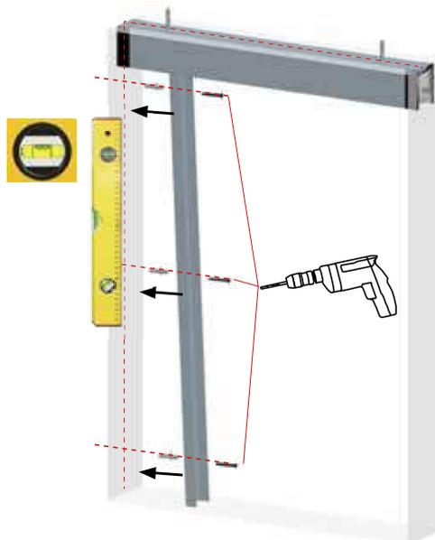
Colocar el perfil lateral izquierdo en forma de U y nivelar. Perforar y fijar el perfil al hueco mediante tornillos.
